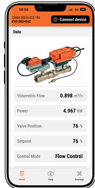
\* 可用数据，菜单栏，重置/重启和状态取决于连接的搏力谋设备。有关详细信息，请参阅您搏力谋设备的数据参数表。
