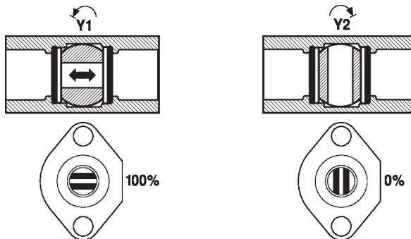
**Debi ayarı** Motorun dönme açısı bir klips yardımıyla  $2,5^\circ$  kademelerle değiştirilebilir. Bu, kvs değerini ayarlamak için kullanılır (vananın maksimum debisi).
