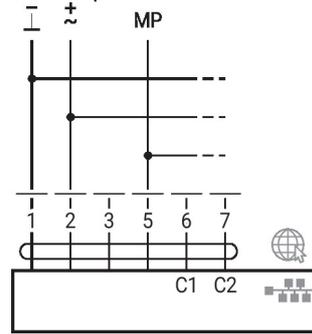
PoE com BACnet/IP / Modbus TCP
