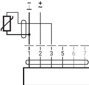
Conexão com contato switch
