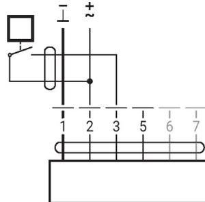
Conexão com sensor ativo
