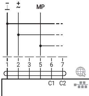
MP-Bus via conexão de fio duplo, fonte de alimentação local
