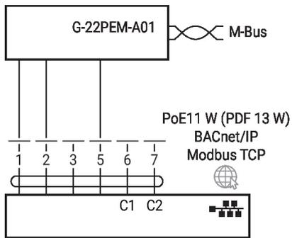
M-Bus com conversor em modo paralelo com BACnet/IP / Modbus TCP
