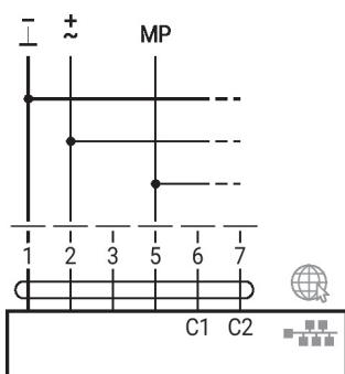
MP-Bus via conexão de fio duplo,
