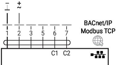
PoE com BACnet/IP / Modbus TCP
