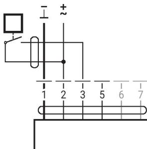
Conexão com sensor ativo
