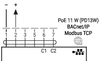
MP-Bus, alimentação via conexão de fio triplo
