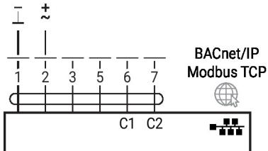
PoE com BACnet/IP / Modbus TCP
