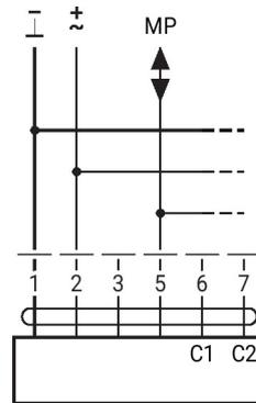
MP-Bus via conexão de fio duplo, fonte de alimentação local
