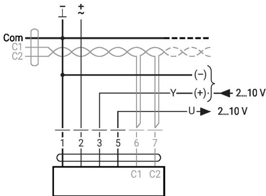
MP-Bus, alimentação via conexão de fio triplo
