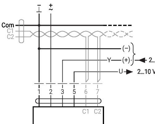
MP-Bus, alimentação via conexão de fio triplo
