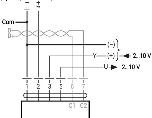
BACnet MS/TP / Modbus RTU
