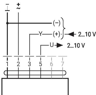
Modbus RTU/BACnet MS/TP com valor de referência analógico
