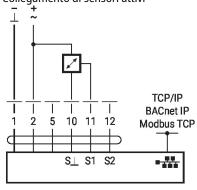
TCP/IP (Cloud) / BACnet IP / Modbus TCP con setpoint analogico (funzionamento ibrido)
