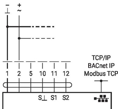
TCP/IP (Cloud) / BACnet IP / Modbus TCP con setpoint analogico (funzionamento ibrido)
