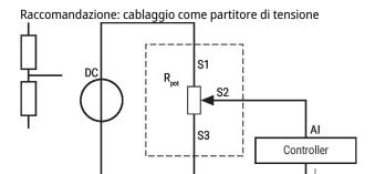
Se il potenziometro viene utilizzato principalmente nello stesso range di angolo ridotto, si consiglia di cablarlo come divisore di tensione.
