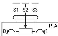
Raccomandazione: cablaggio come partitore di tensione
