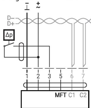
Requisiti per il contatto in commutazione: il contatto di commutazione deve essere in grado di scambiare accuratamente una corrente di 16 mA @ 24 V. Il punto iniziale del range di funzionamento deve essere parametrizzato sull'attuatore MOD come  $\geq 0.5$  V.
