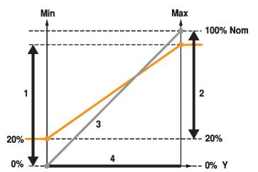
Valore nominale (impostazione OEM) Nom Regolazione range Min 1 Regolazione range Max 2 Feedback U 0...100% Nom 3 Controllo Y Min...Max 4
