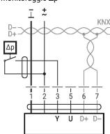
Requisiti per il contatto in commutazione: il contatto di commutazione deve essere in grado di scambiare accuratamente una corrente di 16 mA @ 24 V.
