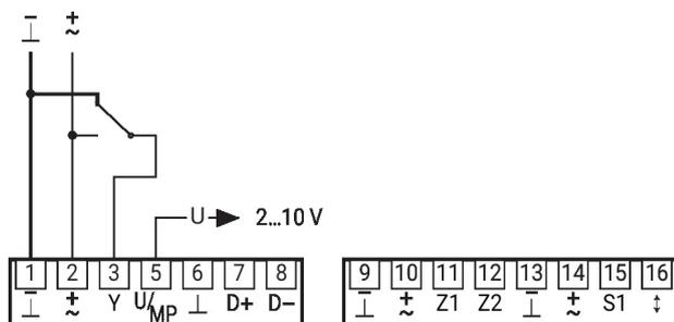
AC/DC 24 V, commande forcée z1/z2
