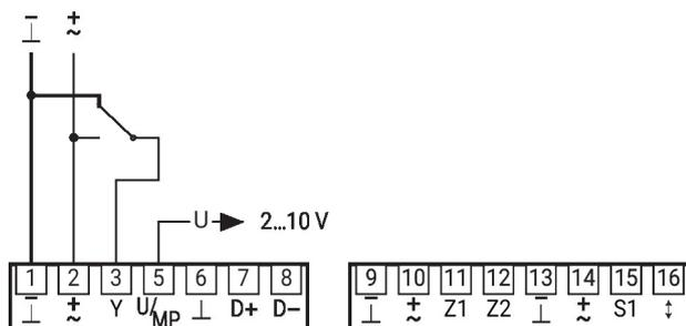
**Règle de priorité – Commande analogique à volume d'air variable (a)**
