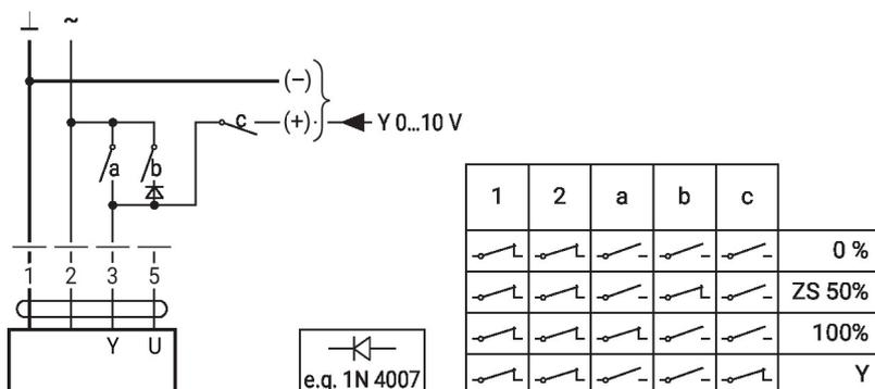
Commande forcée avec commutateur rotatif AC 24 V
