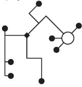
Il n'y a pas de restrictions dans la façon de câbler (en étoile, en boucle, « arbre », ou formes mixtes admises).
