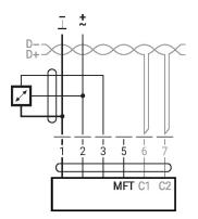
Plage de tension d'entrée admissible : 0...10 V Résolution 30 mV
