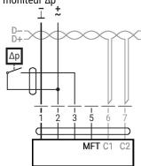
Exigences relatives au contact de commutation : le contact de commutation doit pouvoir commuter un courant de 16 mA à 24 V avec précision. Le début de la plage de travail doit être paramétré sur le servomoteur MOD à  $\geq$  0,5 V.
