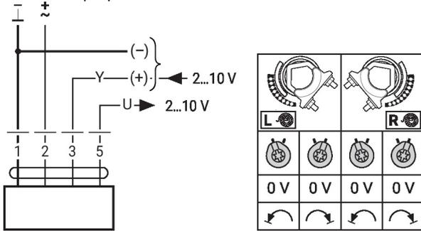
Schéma de câblage pour fonctionnement piggy-back (servomoteurs couplés de manière mécanique)
