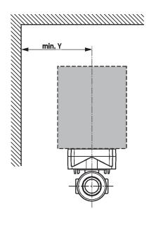
X/Y: Distance minimum par rapport au milieu de la vanne. Les dimensions du servomoteur sont indiquées dans la fiche technique correspondant au servomoteur.
