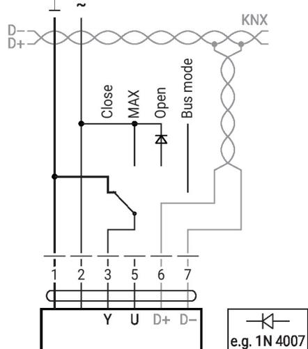
Si aucun capteur n'est intégré, le raccordement 3 (Y) est alors disponible pour une commande forcée locale.
