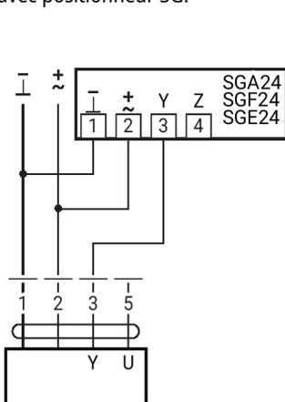
Limitation minimale avec positionneur SG.
