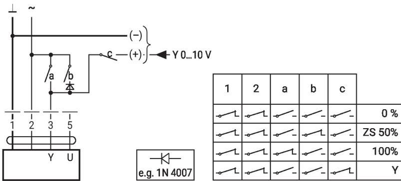
Commande à distance 0...100% avec positionneur SG.
