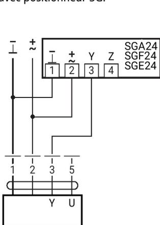
Limitation minimale avec positionneur SG.
