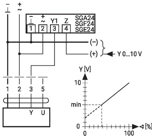
Commande forcée avec commutateur rotatif AC 24 V
