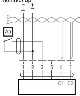
Exigences relatives au contact de commutation : le contact de commutation doit pouvoir commuter un courant de 16 mA à 24 V avec précision.
