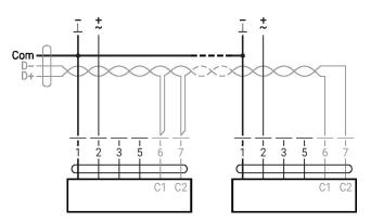
Modbus RTU / BACnet MS/TP avec point de consigne analogique (fonctionnement hybride)
