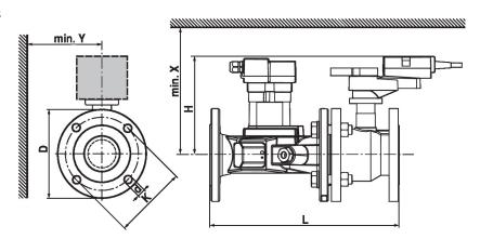
Si Y < 180 mm, la rallonge de la manivelle à main doit être démontée si nécessaire.
