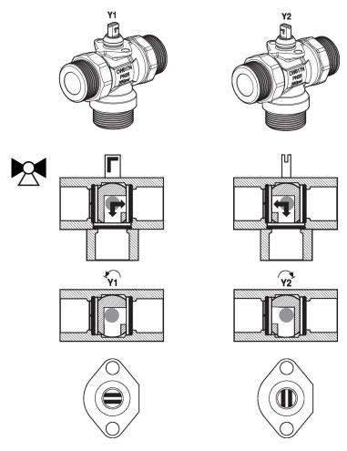
**Réglage de débit** Le clip pour butée au niveau du servomoteur doit être retiré afin d'obtenir l'angle de rotation de 90 ° nécessaire à la fonctionnalité de commutation change-over.
