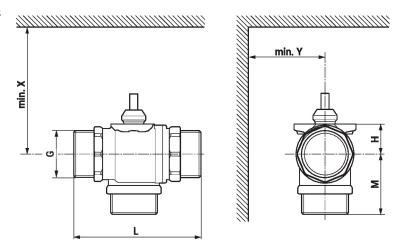
X/Y: Distance minimum par rapport au milieu de la vanne. Les dimensions du servomoteur sont indiquées dans la fiche technique correspondant au servomoteur.
