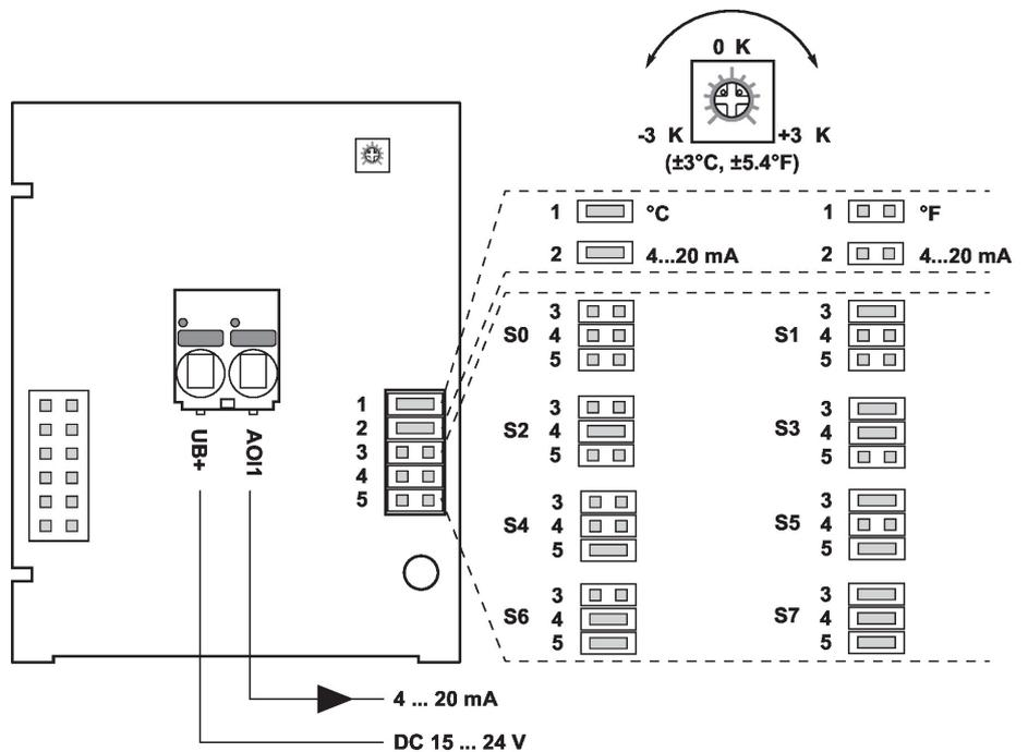
Les plages de mesure suivantes peuvent être réglées à l'aide des paramètres du cavalier :
