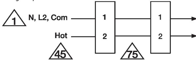
Câblage en parallèle des servomoteurs
