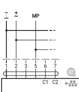
MP-Bus par un raccordement à 2 fils, alimentation locale
