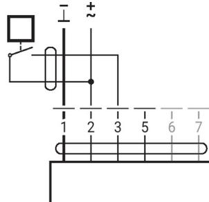
Connexion avec capteur actif
