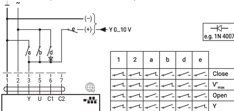
Commande de surpassement et limitation avec alimentation DC 24 V par des contacts relais (avec commande classique ou hybride)
