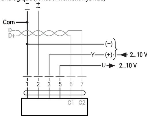
BACnet MS/TP / Modbus RTU
