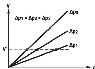
**Courbe de régulation** La vitesse du fluide est mesurée au moyen d'un élément de mesure (système électronique du capteur) et convertie en un signal de débit.
