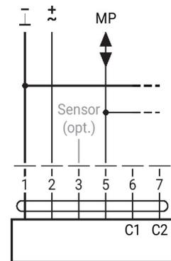
Exemples de câblage externe avec des servomoteurs de type ..24GX..
