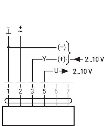
Connexion Modbus MS/TP / BACnet RTU avec point de consigne analogique (fonctionnement hybride)
