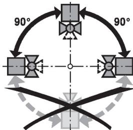
**Installation dans la conduite de retour** Installation dans la conduite de retour recommandée.
