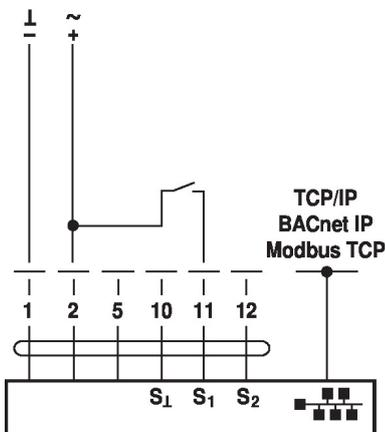
TCP/IP (nuage) / BACnet/IP / Modbus TCP avec point de consigne analogique (fonctionnement hybride)
