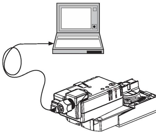
**Inversion du signal de commande** Le signal de positionnement peut être inversé si un signal analogique est utilisé. L'inversion provoque le renversement du comportement standard, c'est-à-dire que pour le signal de positionnement 0 %, le servomoteur est ouvert au maximum et pour le signal de positionnement 100 %, le servomoteur est fermé.
