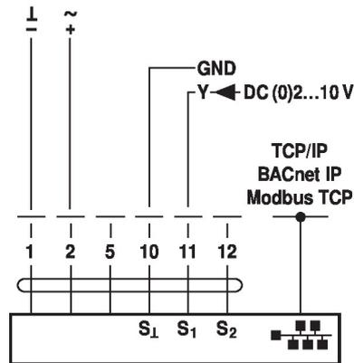
Connexion des capteurs actifs
