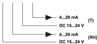
Les valeurs de température correctes sont uniquement disponibles lorsque la sortie d'humidité AOI1 et les deux entrées UB + sont connectées.
