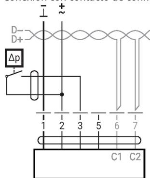
Requisitos del contacto de conmutación: El contacto de conmutación debe poder conmutar con precisión una corriente de 16 mA con 24 V.
