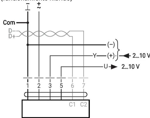
BACnet MS/TP/Modbus RTU
