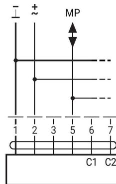
MP-Bus con conexión a 2 cables, fuente de alimentación local
