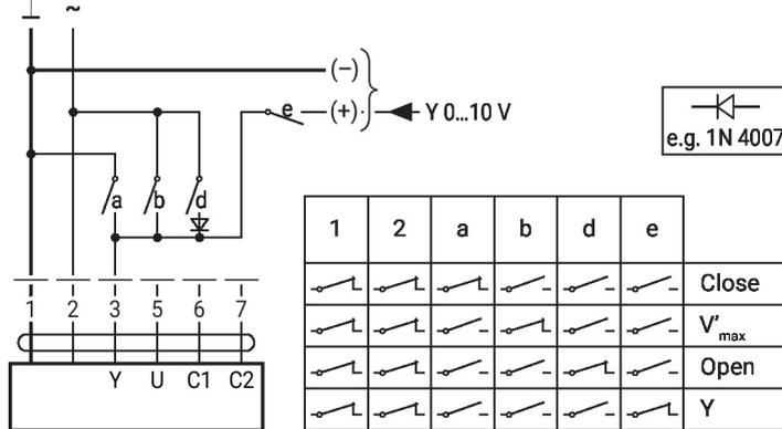
Control de sobremando y limitación con DC 24 V y contactos del relevador (con control convencional o modo híbrido)
