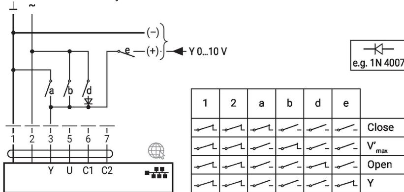
Control de sobremando y limitación con DC 24 V y contactos del relevador (con control convencional o modo híbrido)
