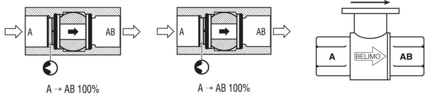
Las válvulas de dos vías se deben instalar con el disco en dirección opuesta al flujo.
