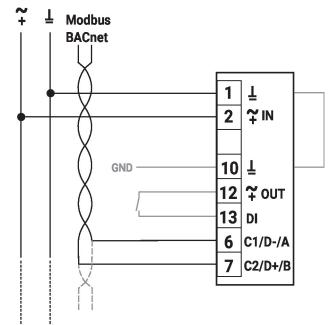
GND = 1 AC/DC 24 V = 2 GND = 10 Entrada digital, por ejemplo, detector de presencia = 12/13 C1/D-/A = 6 C2/D+/B = 7
