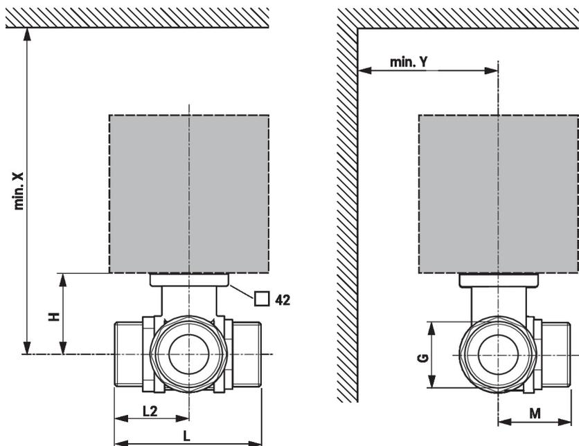
X/Y: mínima distancia con respecto al centro de la válvula. Las dimensiones del actuador pueden encontrarse en la ficha de datos del actuador correspondiente.
