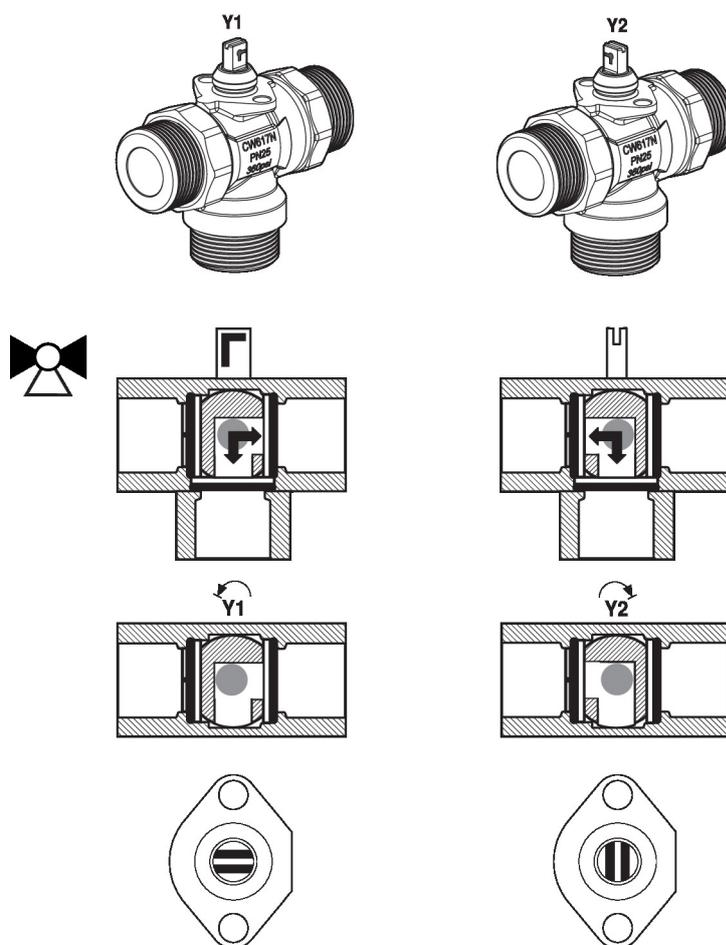
**Ajuste de caudal** Debe retirarse el tope final mecánico en el actuador para obtener un ángulo de giro de 90°, necesario para la funcionalidad de cambio de régimen.
