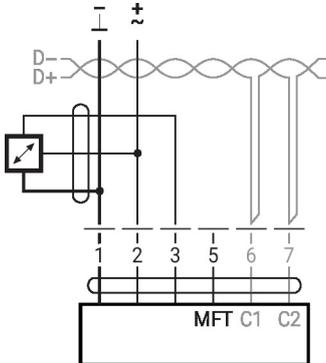
Möglicher Eingangsspannungsbereich: 0...10 V
