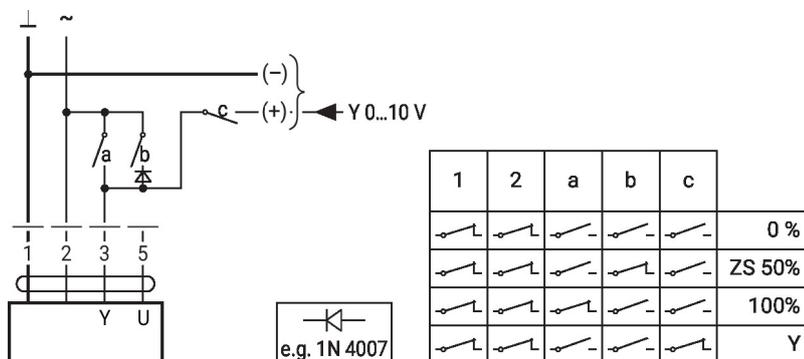
Zwangssteuerung mit AC 24 V mit Drehschalter
