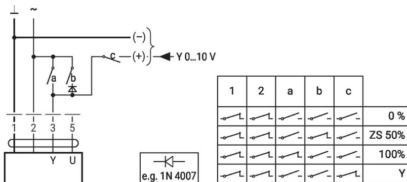
Zwangssteuerung mit AC 24 V mit Drehschalter
