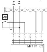
Anforderungen Schaltkontakt: Der Schaltkontakt muss in der Lage sein, einen Strom von 16 mA @ 24 V exakt zu schalten.
