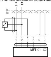
Möglicher Eingangsspannungsbereich: 0... 10 V Auflösung 30 mV Anschluss mit Schaltkontakt, z.B. Δp-Wächter
