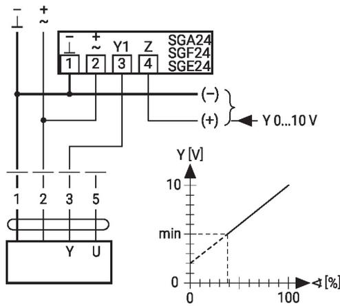
Zwangssteuerung mit AC 24 V mit Drehschalter
