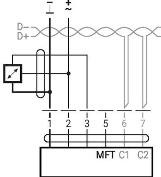
Möglicher Eingangsspannungsbereich: 0...10 V
