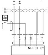
Anforderungen Schaltkontakt: Der Schaltkontakt muss in der Lage sein, einen Strom von 16 mA @ 24 V exakt zu schalten.
