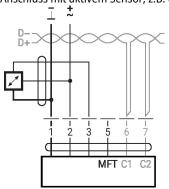
Möglicher Eingangsspannungsbereich: 0... 10 V Auflösung 30 mV
