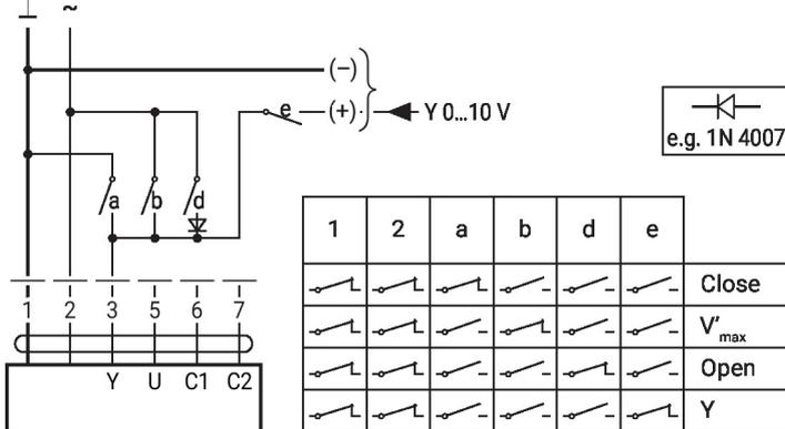
Zwangssteuerung und Begrenzung mit DC 24 V mit Relaiskontakten (konventioneller Betrieb oder Hybridbetrieb)
