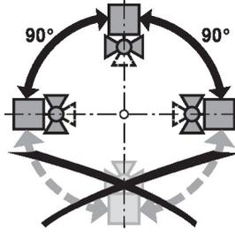
**Einbauort im Rücklauf** Der Einbau im Rücklauf wird empfohlen.
