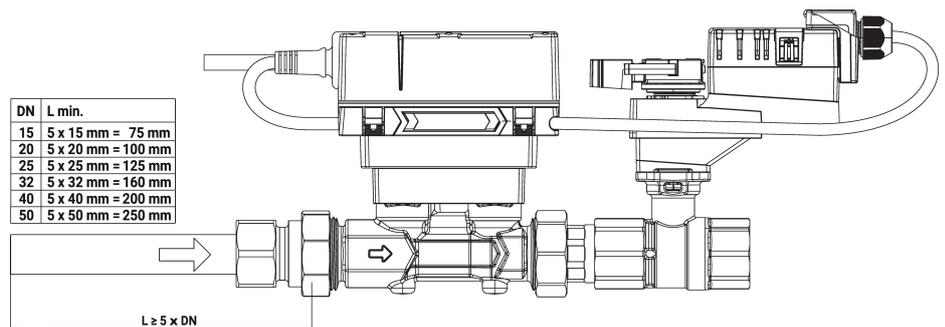
**Getrennte Installation** Die Ventil-Antrieb-Kombination darf getrennt vom Durchflusssensor montiert werden. Dabei ist die Durchflussrichtung beider Komponenten zu beachten.
