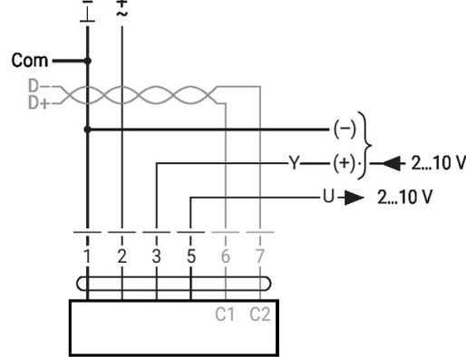
BACnet MS/TP / Modbus RTU
