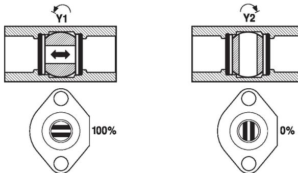
**Durchflusseinstellung** Der Drehwinkel des Antriebes kann mittels Clip in 2.5°-Schritten verändert werden. Dies dient dazu, den kvs-Wert (maximaler Durchfluss des Ventils) einzustellen.
