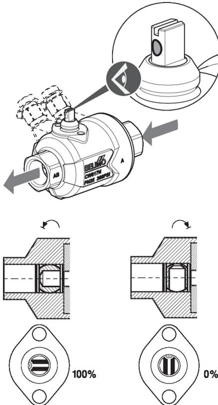
**Ajuste de fluxo** O ângulo de rotação do atuador CQ.. pode ser alterado pelo clipe fim-de-curso em incrementos de 2,5°. Isso é usado para definir o valor V'max (vazão máxima da válvula).
