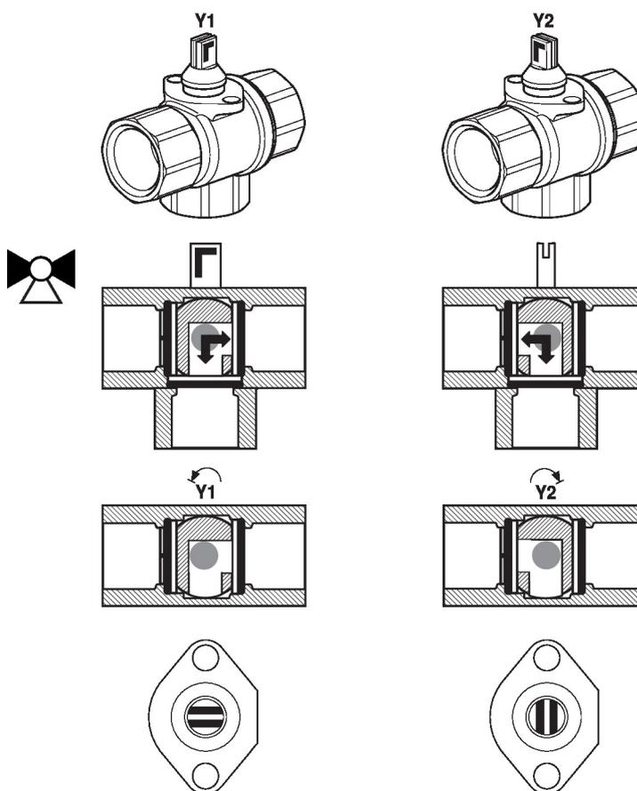
**Réglage de débit** Au niveau du servomoteur, la butée de fin de course encliqueter doit être retirée afin d'obtenir l'angle de rotation de 90° nécessaire à la fonctionnalité de commutation.
