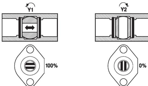
**Réglage de débit** L'angle de rotation du servomoteur est réglable, à l'aide d'une pince, par incréments de 2,5°. Cela sert à régler la valeur de kvs (débit maximal du robinet).
