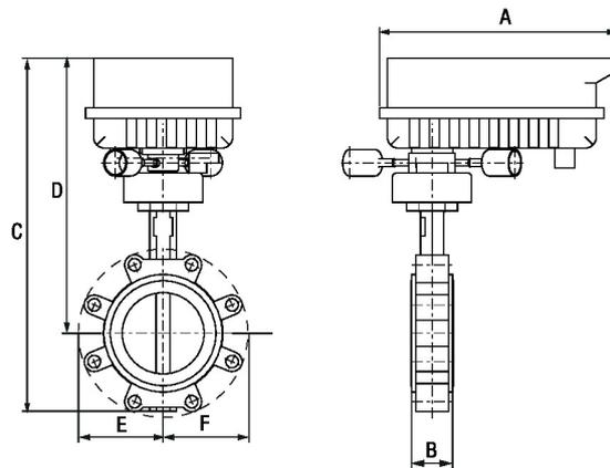
Robinet avec servomoteur PRB(X)
