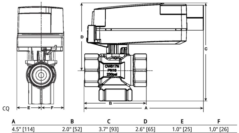
On/Off (Encendido/Apagado), Función de protección eléctrica a prueba de fallas, 24 V
